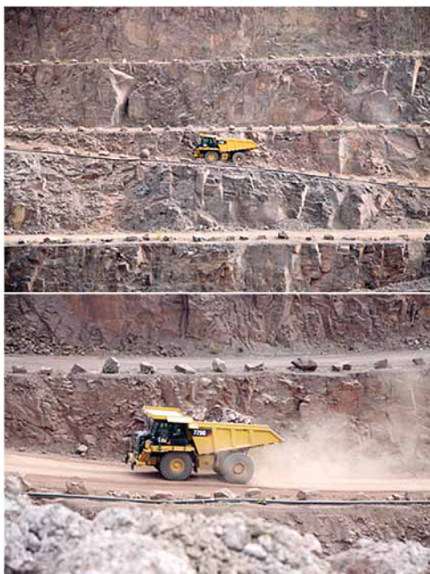
Der rote Andesit wird aus dem Tagebau zum Vorbrecher befördert.
