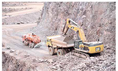
Das gesprengte Haufwerk verlädt etwa ein Cat Kettenbagger 374DL auf Muldenkipper wie einen 775G. Fotos: Zeppelin
